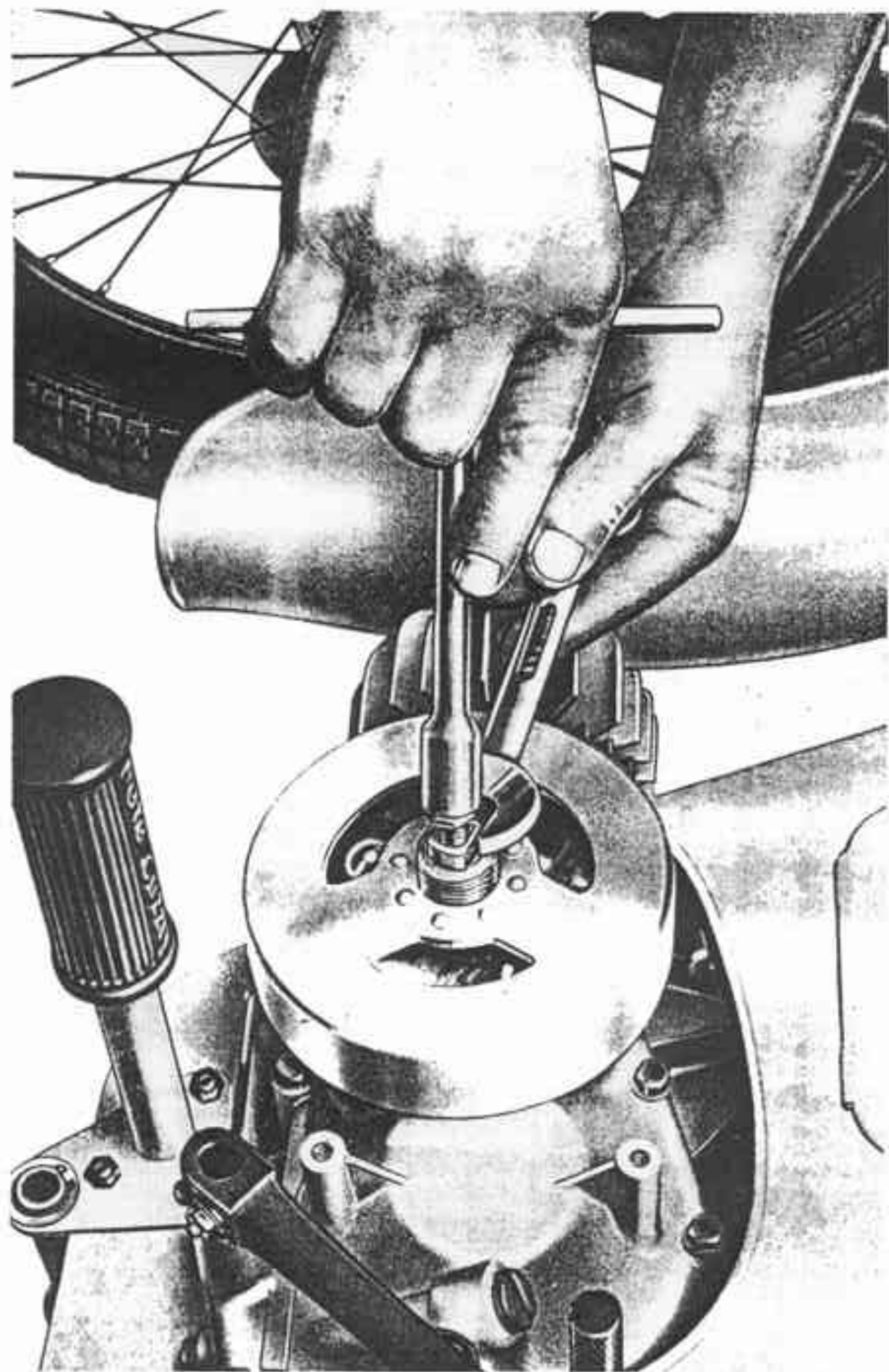
Fig. 3 - Smontaggio dell'alternatore Volano
